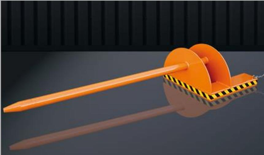
Massiver Tragedorn für den Transport von Rohren, Hohlkörpern und Teppichrollen von 1.000 bis 2.500kg. In verschiedenen Längen und Gewichtsklassen lieferbar, inklusive Sicherungskette zum Schutz vor ungewolltem Abrutschen.
